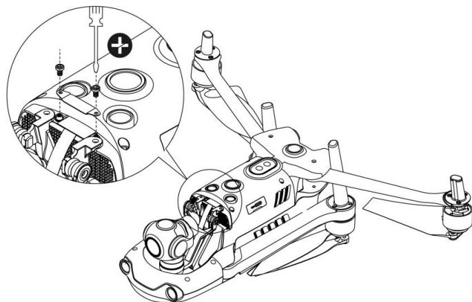
3. 将一颗螺钉插入云台装饰件的一个孔中，然后用一把 T6 螺丝刀将其拧入，直至螺钉起到固定作用但不要拧紧。对另一颗螺钉重复该步骤。用螺丝刀充分拧紧两颗螺钉。
