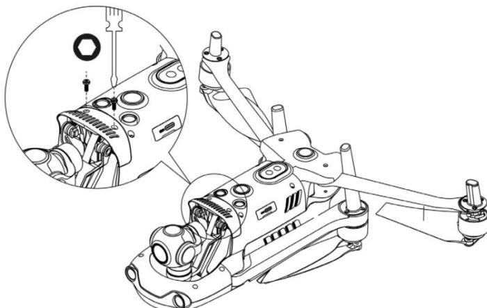
4. 打开飞行器的电源开关。若云台的连接器电缆连接正确，云台将自动旋转执行自检。
